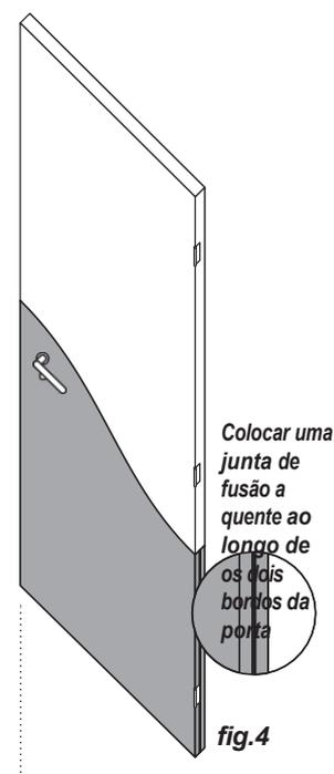
Aplicação de juntas termofusíveis ao longo da linha de centro dos bordos da porta torna o painel muito mais resistente a ser arrancado e melhora a sua estanquidade.
